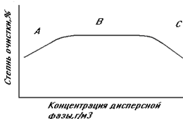
Рис. 9.6. Характер зависимости степени очистки газов от концентрации дисперсной фазы
