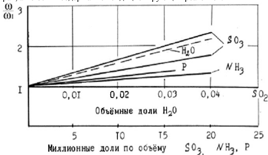
Рис. 8.4. Эффективность действия различных кондиционирующих добавок
