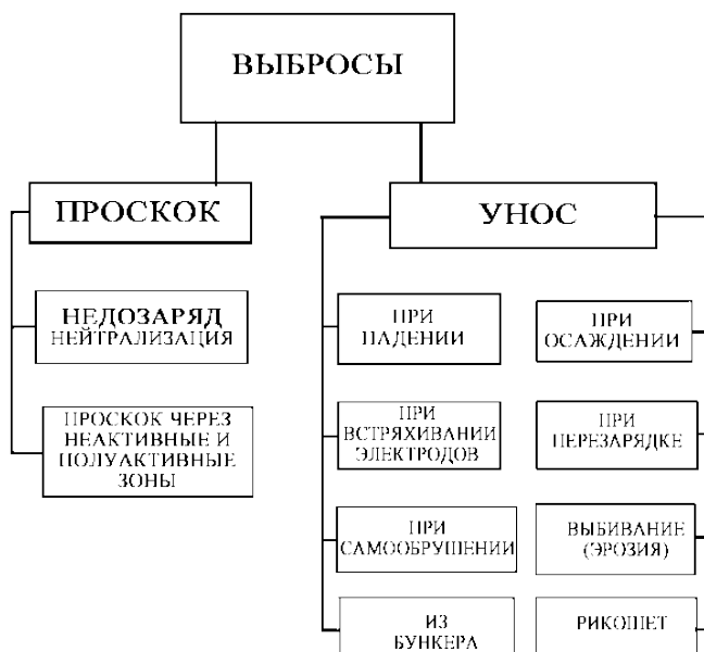
Рис. 7.4. Классификация выбросов пыли из электрофильтра
